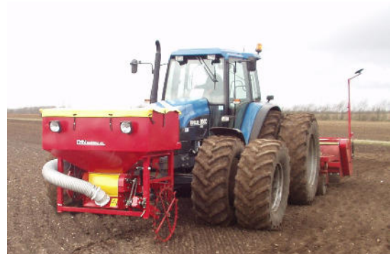
Frontmonteret såtank på CMN Kvik-killer 4 m
